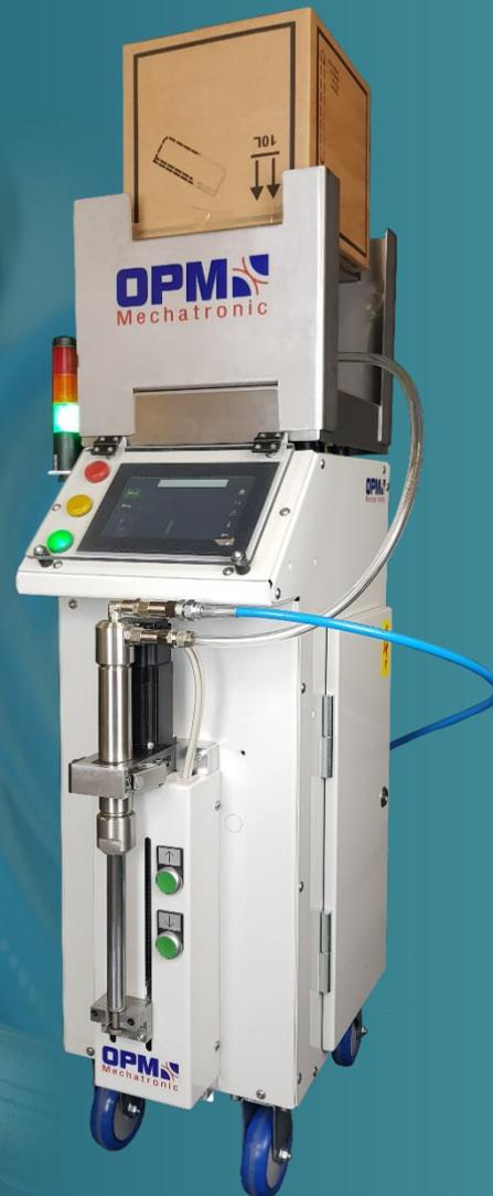
Das von OPM Mechatronic GmbH entwickelte Dosiersystem ermöglicht einen sauberen und präzisen Dosierprozess von Flüssigfarben und Additiven in der Kunststoffverarbeitung.
