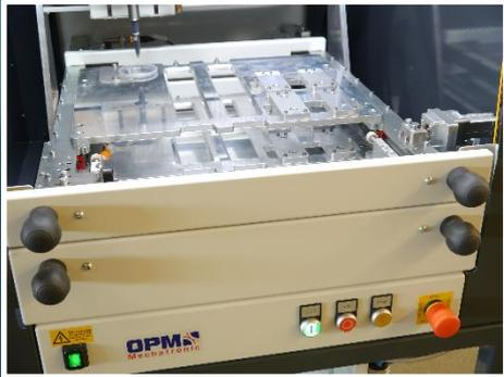
Mit der optional erhältlichen Doppelschublade hat man die Möglichkeit eine Schublade zu beschicken, während zeitgleich dann die zweite Schublade vom Tischroboter bearbeitet wird. So ist eine effiziente Auslastung der Anlage möglich. Die Zykluszeiten werden durch das parallele Beschicken der Schubladen herabgesetzt. (Für diese Option ist ein Optionspaket aus Hardware und Software notwendig)
