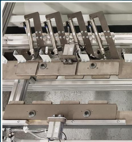
Es können bis zu 8 externe Funktionen mit Rückmeldesignal konfiguriert werden. Mit diesen Funktionen lassen sich z. B. Zentrier- oder Haltefunktionen realisieren. Die Funktionen lassen sich direkt aus dem CNC-Programm heraus ansteuern. Jede Funktion wird mit zwei Ausgängen ausgestattet, so dass man z. B. direkt pneumatische Ventile ansteuern kann. Zu jeder Funktion können zwei Abfragen konfiguriert werden. (Für diese Funktion sind digitale Ausgänge bzw. Eingänge vorzusehen)
